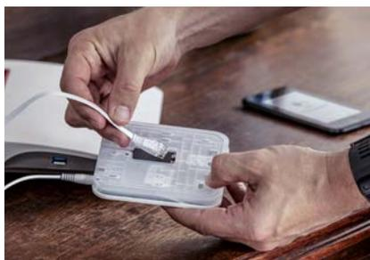
2. Branchement de la passerelle réseau RE.HUB au routeur.
