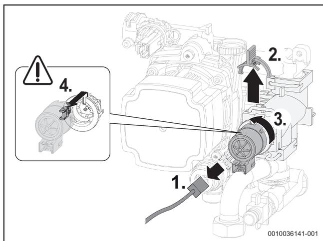
Fig. 61 Retrait du moteur de la vanne sélective (variante sans vis)
