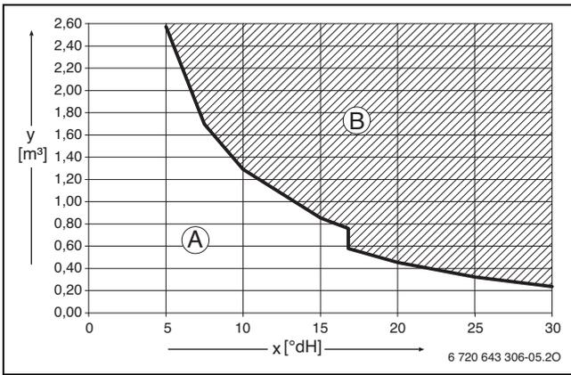
Fig. 21 Conditions requises pour l'eau de remplissage et d'appoint en °dH sur les appareils < 50 kW
