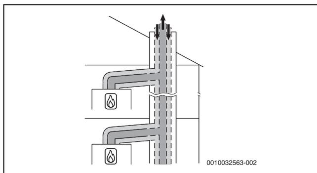
Fig. 16 Raccordement de plusieurs foyers selon C<sub>43</sub> avec circuit d'air et de fumées concentrique dans le local d'installation
