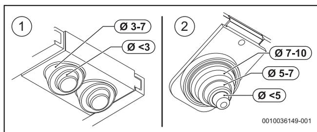
Fig. 33 Adaptation des gaines au diamètre du câble
