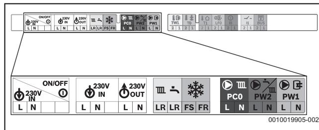
Fig. 36 Bornier pour alimentation électrique (câbles de réseau)
