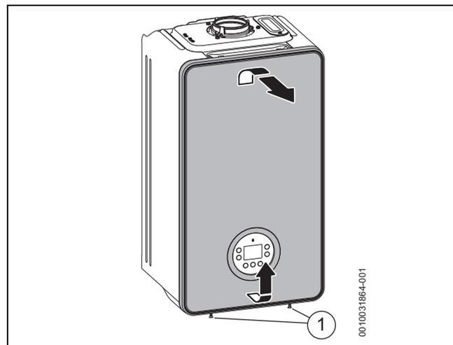
Fig. 25 Démontage de l'habillage avant
