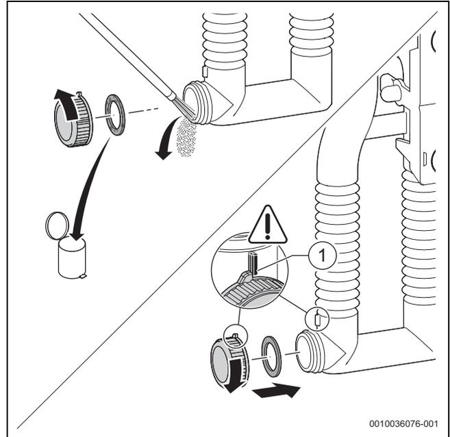
Fig. 54 Nettoyage du siphon de condensats
