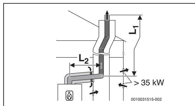
Fig. 14 Evacuation des fumées flexible dans le conduit selon B<sub>33</sub> avec arrivée d'air dépendant de l'air ambiant par le circuit d'air et de fumées concentrique dans le local d'installation
