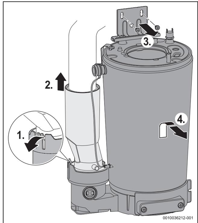
Fig. 66 Démontage du corps de chauffe
