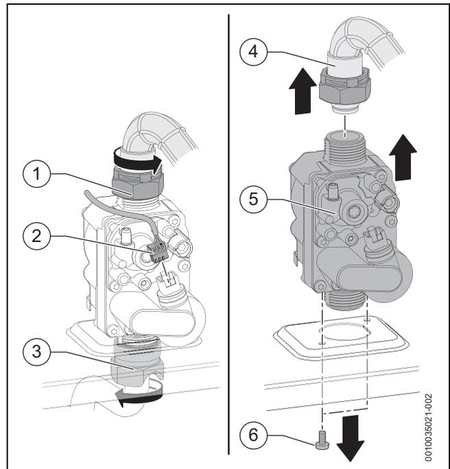
Fig. 60 Démontage du bloc gaz
