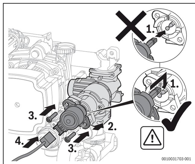
Fig. 64 Installation du moteur dans la vanne sélective (variante avec vis)
