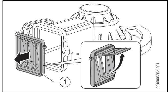
Fig. 47 Clapet anti-retour (plaque d'appui) dans l'unité de mélange
