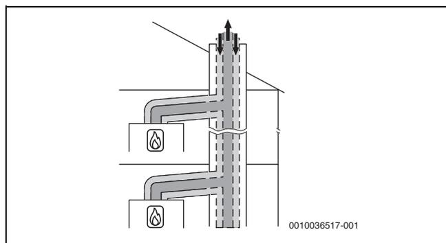
Fig. 17 Raccordement de plusieurs foyers selon C<sub>43p</sub> avec circuit d'air et de fumées concentrique dans le local d'installation
