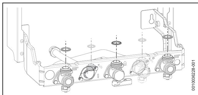
Fig. 24 Montage des joints sur les vannes d'isolement
