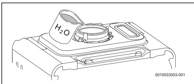
Fig. 31 Remplir le siphon des condensats avec de l'eau
