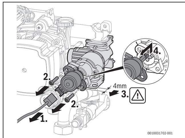
Fig. 63 Retrait du moteur de la vanne sélective (variante avec vis)
