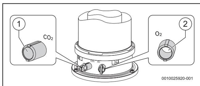
Fig. 44 Tubulure de mesure des fumées et point de mesure de l'air de combustion
