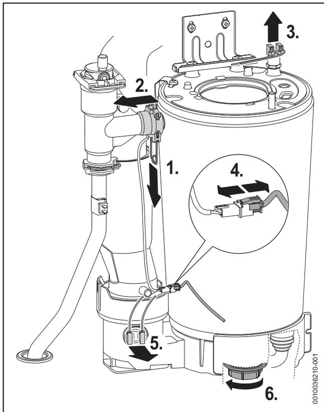
Fig. 65 Séparation des composants du corps de chauffe
