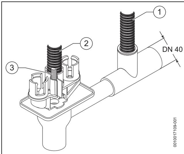
Fig. 30 Montage des tubes de vidange sur le siphon
