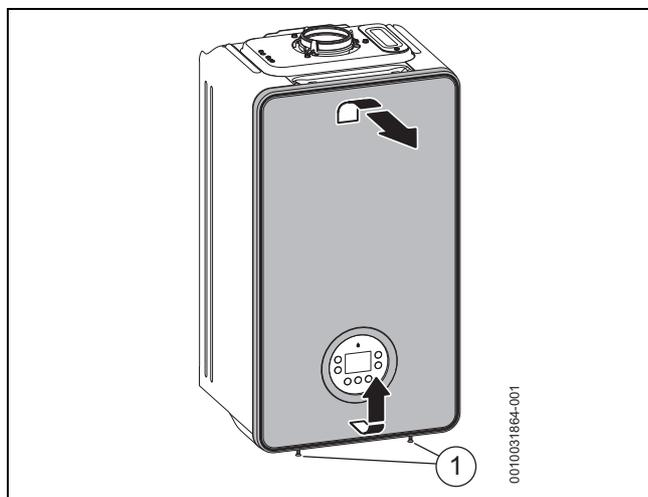
Fig. 39 Démontage de l'habillage avant
