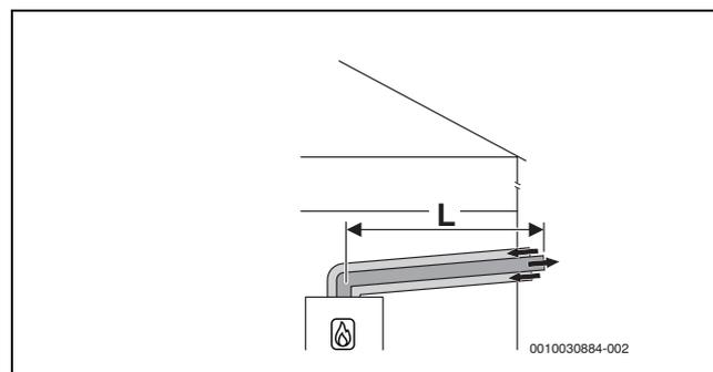
Fig. 9 Circuit d'air et de fumées concentrique horizontal selon C<sub>13x</sub> par le mur extérieur
