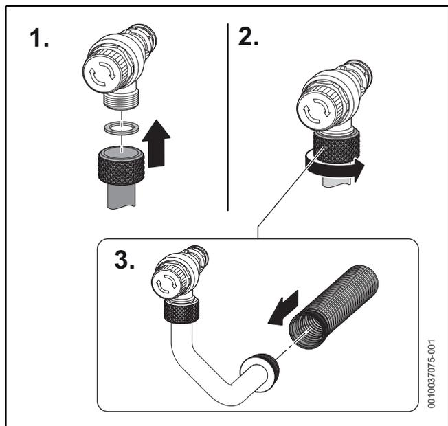
Fig. 28 Montage du tube sur la soupape de sécurité (chauffage)
