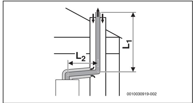
Fig. 11 Evacuation des fumées rigide selon C<sub>93x</sub> dans le conduit et circuit d'air et de fumées concentrique dans le local d'installation
