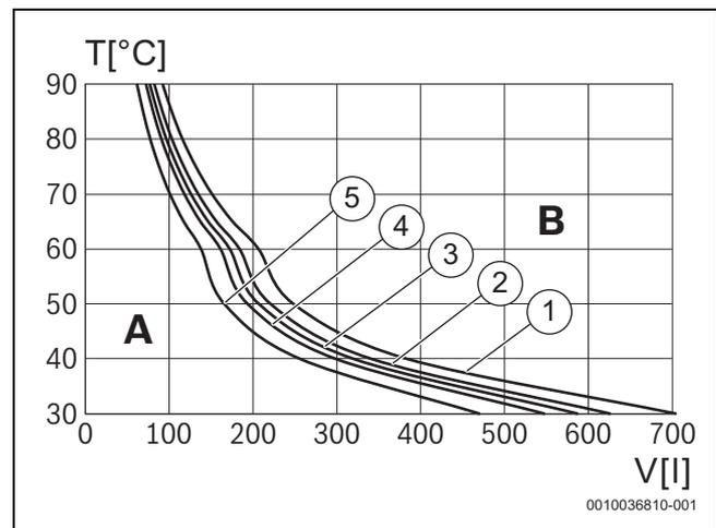
Fig. 23 Courbes caractéristiques du vase d'expansion
