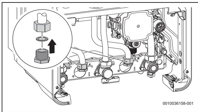
Fig. 27 Fixation du set de bouchons pour tuyaux de ballon
