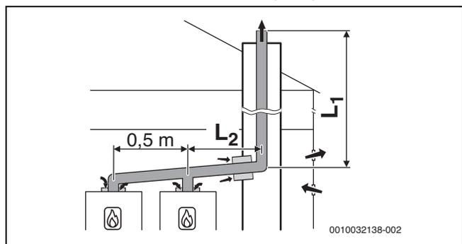
Fig. 18 Cascade avec 2 appareils : évacuation des fumées dans le conduit rigide selon B<sub>23p</sub>/B<sub>53p</sub> avec arrivée d'air dépendant de l'air ambiant sur l'appareil
