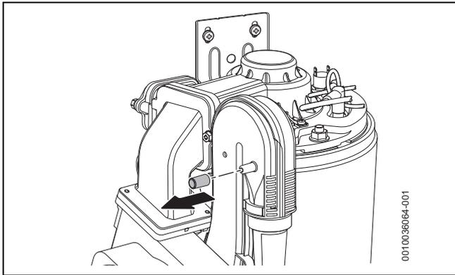
Fig. 59 Tubulure de mesure sur le dispositif de mélange
