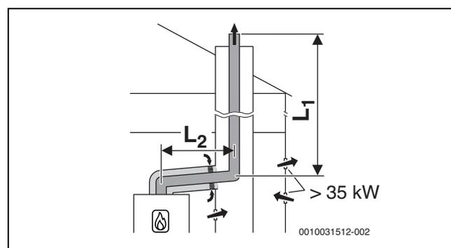
Fig. 13 Evacuation des fumées rigide dans le conduit selon B<sub>33</sub> avec arrivée d'air dépendant de l'air ambiant par le circuit d'air et de fumées concentrique dans le local d'installation
