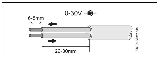
Fig. 35 Préparation de la basse tension (câbles de signaux)
