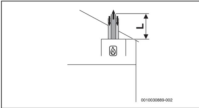
Fig. 10 Circuit d'air et de fumées vertical concentrique selon C<sub>33x</sub>
