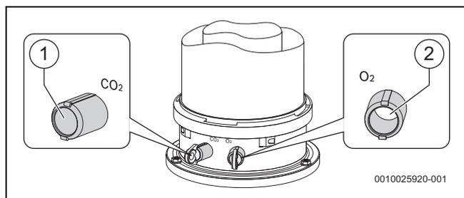
Fig. 41 Tubulure de mesure des fumées et point de mesure de l'air de combustion
