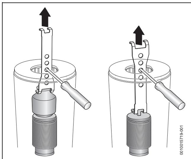
Fig. 49 Retirer les déflecteurs supérieur et inférieur.
