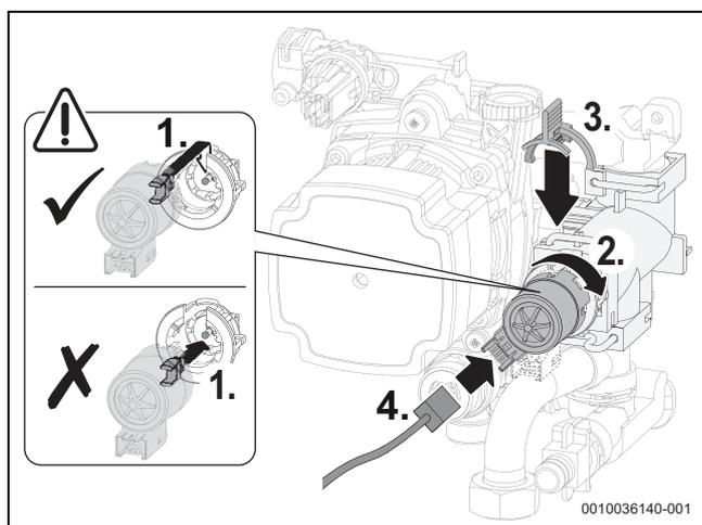
Fig. 62 Installation du moteur dans la vanne sélective (variante sans vis)
