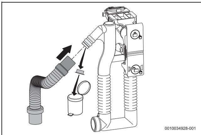
Fig. 29 Installation du tube sur le siphon de condensats
