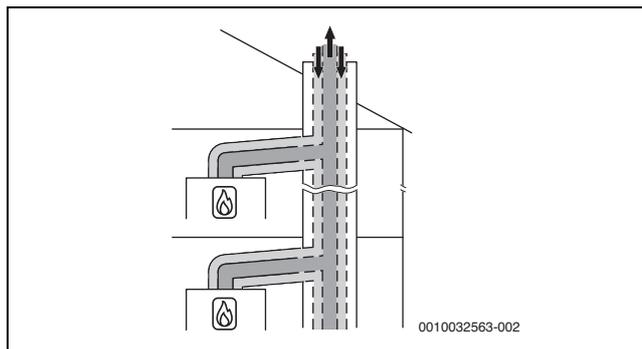
Fig. 15 Raccordement de plusieurs foyers selon C<sub>(10)3x</sub> avec circuit d'air et de fumées concentrique dans le local d'installation
