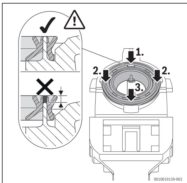
Fig. 57 Pression sur le joint
