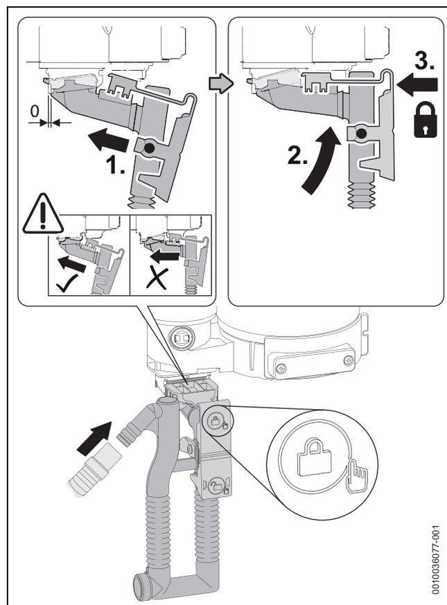
Fig. 58 Insertion du siphon de condensats
