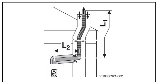
Fig. 12 Evacuation des fumées flexible selon C<sub>93x</sub> dans le conduit et circuit d'air et de fumées concentrique dans le local d'installation
