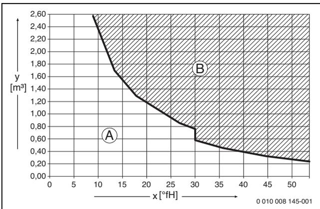
Fig. 22 Conditions requises pour l'eau de remplissage et d'appoint en °fH sur les appareils < 50 kW
