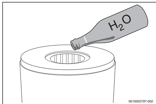
Fig. 51 Rinçage de l'échangeur thermique avec de l'eau
