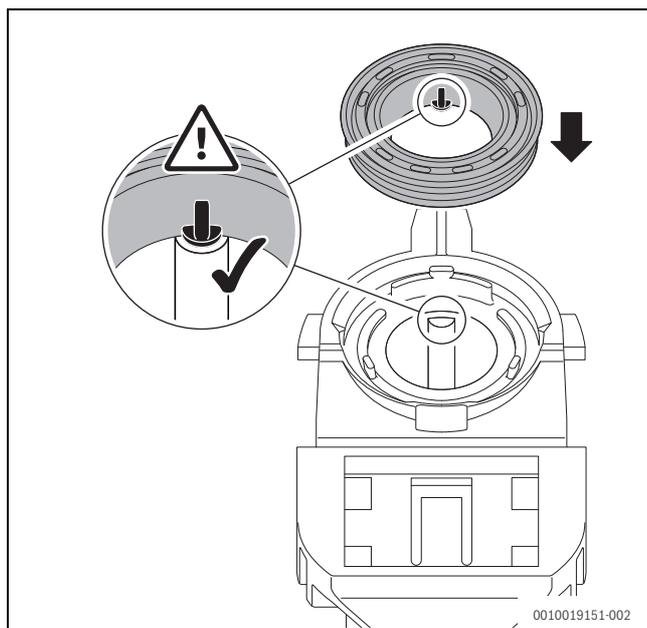
Fig. 56 Alignement du joint sur le siphon de condensats
