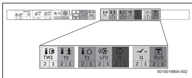
Fig. 37 Bornier pour basse pression (câbles de signaux)
