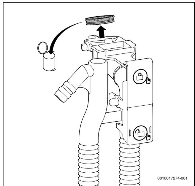
Fig. 55 Retrait du joint sur la partie supérieure du siphon de condensats
