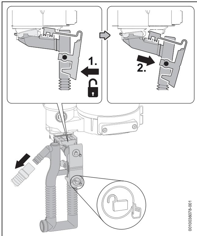
Fig. 53 Retrait du siphon de condensats
