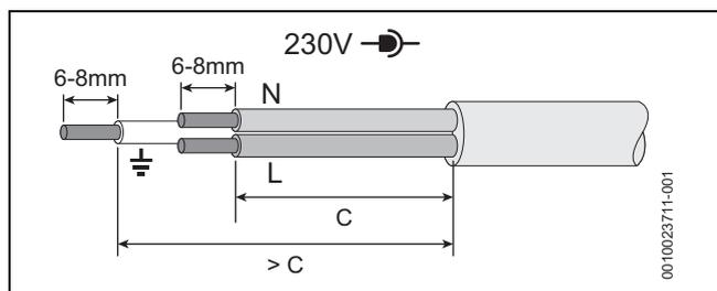
Fig. 34 Préparation de l'alimentation électrique (câbles de réseau)
