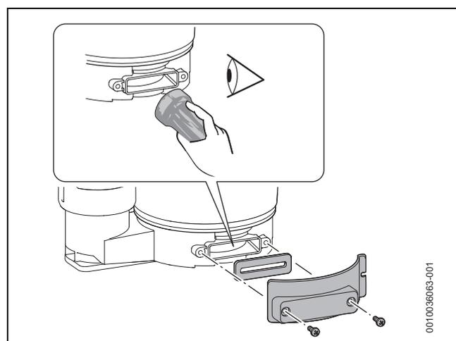
Fig. 52 Vérification de la présence éventuelle de résidus dans l'échangeur thermique
