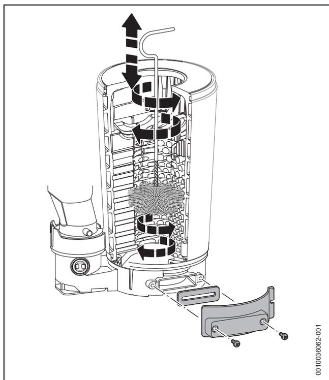
Fig. 50 Nettoyage de l'échangeur thermique
