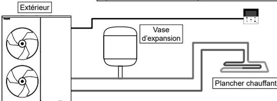
Raccordez le plancher chauffant ou le radiateur directement à l'unité extérieure.
