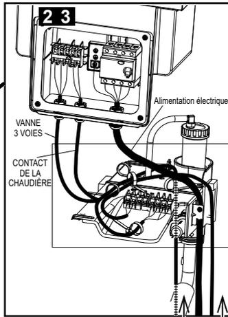
\*Le câble d'alimentation ne doit pas entrer en contact avec d'autres câbles.
