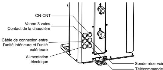
Tirez le câble d'alimentation et le câble de connexion à travers le trou du câble de connexion **13** comme indiqué sur l'illustration.
