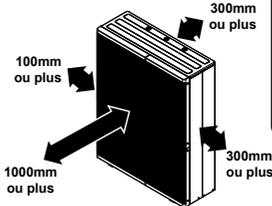
Il est conseillé d'éviter l'utilisation de 2 sens d'obstruction. Pour une meilleure ventilation et des installations extérieures multiples, consultez un revendeur/expert agréé.
