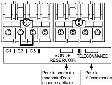
Lors de la connexion à une unité intérieure, retirez les fils de court-circuit « C2 » et « C3 » et connectez-les comme indiqué dans le diagramme ci-dessous.
