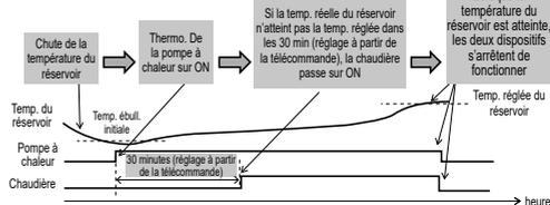
En mode Parallèle avancée, il est possible de procéder en même temps au réglage du chauffage et du réservoir. Lors du fonctionnement du mode « Chauffage/Réservoir », à chaque fois que ce mode est activé, la sortie de la chaudière sera réinitialisée à OFF. Veuillez avoir une bonne connaissance de la caractéristique de la commande de la chaudière afin de sélectionner le réglage optimal du système.
