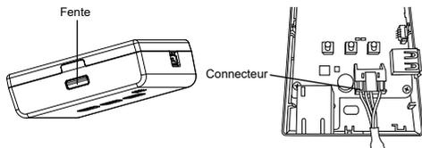
2. Tirez le câble CN-CNT à travers le trou situé au bas de l'adaptateur et remettez le couvercle en place.
