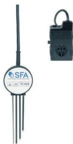
Le régulateur de niveau électronique est utilisé pour le contrôle du niveau de fluides dans des cuves ou des fosses lorsqu'un contrôle très précis est nécessaire ou bien lorsque le niveau d'assèchement des fluides doit être très faible. Il comprend 4 électrodes en acier inoxydable, un porte-électrode, un support de montage, un câble de 10 m et un adaptateur de commande enfichable.
