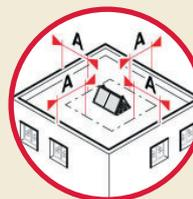
Respectez une distance de sécurité de 1 mètre minimum en supplément de la zone de travail par rapport au bord du toit ou de la terrasse (A = 1 m)
