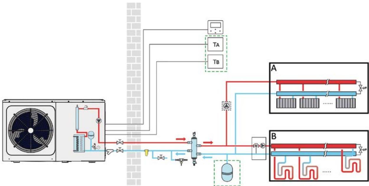
Dans le cadre de l'installation d'une pompe à chaleur monobloc, nous vous conseillons de glycoler l'installation ou d'installer une vanne Exogel à l'extérieur, en partie basse du réseau.
