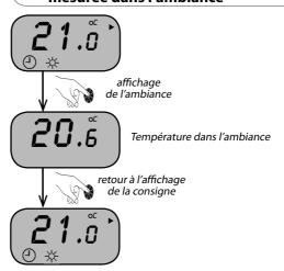
A défaut d'appui sur la molette, le retour à l'affichage courant se fait automatiquement au bout de 30 secondes.
