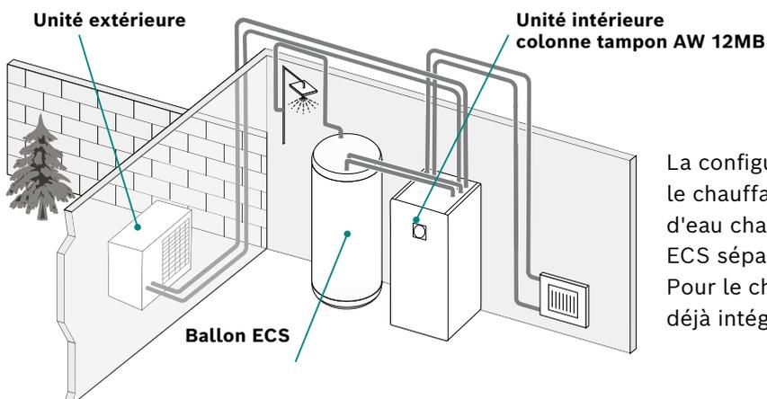
La configuration avec la colonne tampon assure le chauffage seul ou le chauffage + la production d'eau chaude sanitaire (par l'ajout d'un ballon ECS séparé adapté aux besoins du client). Pour le chauffage, le **ballon tampon 70 litres** est déjà intégré dans la colonne.
