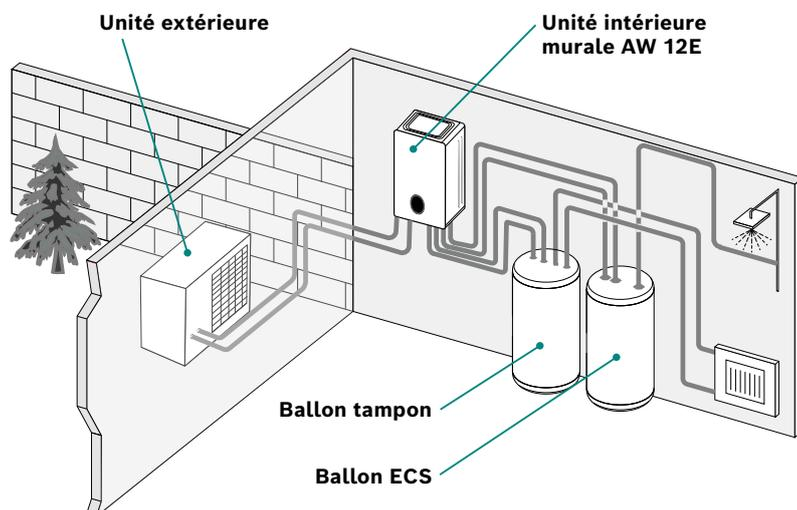
La configuration avec l'unité intérieure murale offre **une flexibilité** à l'installateur pour configurer son système comme il le souhaite : chauffage seul, double service (chauffage + ECS) avec les volumes du ballon tampon ou du ballon ECS **dimensionnés aux besoins du client.**
