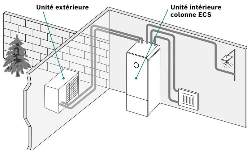
La configuration avec la colonne ECS assure **directement le double service** (chauffage + ECS) avec son ballon tampon 16 litres et son ballon ECS inox 190 litres intégrés.
